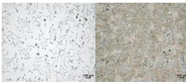
Figura 4 - Micrografias do ferro fundido vermicular classe 400
