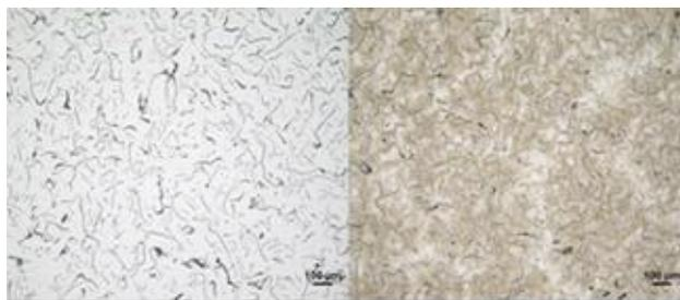
Figura 21 - Micrografias do ferro fundido cinzento classe 300
