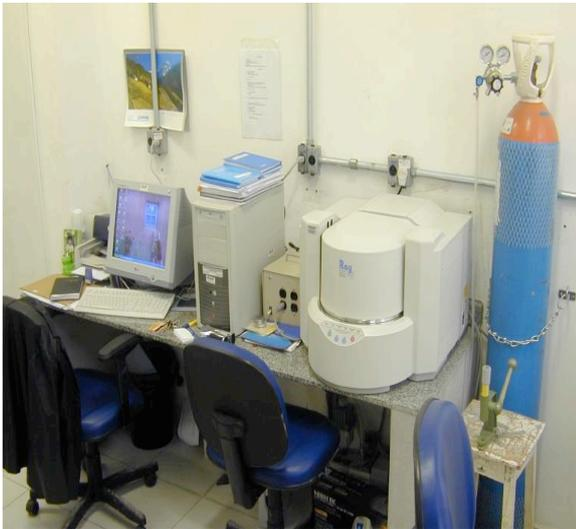
Figura 2 – Equipamento de ED-XRF utilizado no laboratório de biomonitoramento da Faculdade de Medicina da Universidade de São Paulo
