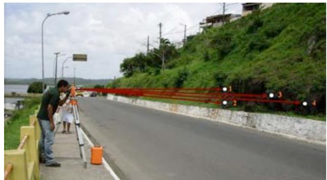
Figura 5 – Marcos topográficos materializados no afloramento rochoso e esquema da rede de monitoramento
