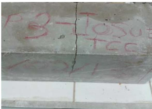
Figura 5 – Ruptura do corpo de prova de CLF
