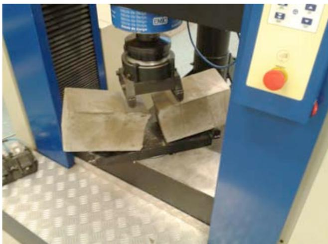
Figura 4 – Ruptura do corpo de prova de CC
