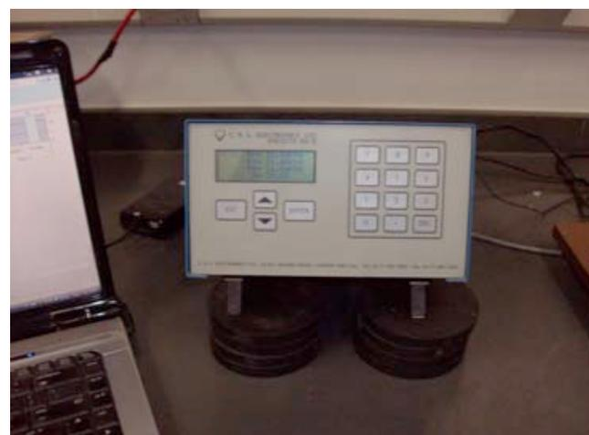
Figura 3 - Equipamento para determinação do módulo de elasticidade dinâmico
