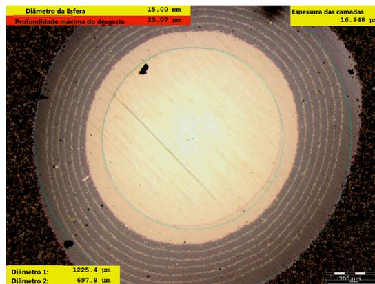
Figura 8 - Calotest do revestimento realizado nas pastilhas
