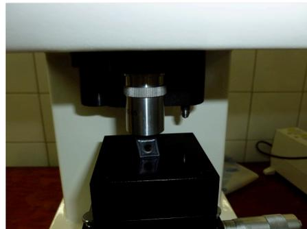
Figura 2 - Microdurômetro Modelo HXD- 1000TM
