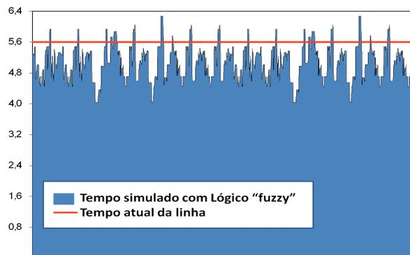
Figura 8 - Parte dos resultados da simulação de 127,2 horas, demonstrando uma redução de 10% do tempo atual
