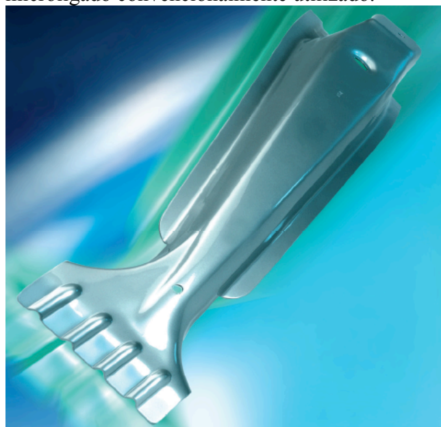
Figura 8 - Exemplo de aplicação do aço Complex Phase pela indústria automotiva, o reforço da coluna B dos veículos. [5]
