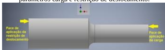
Figura 6 – Componente 2, indicação dos locais de aplicação dos parâmetros carga e restrição de deslocamento.
