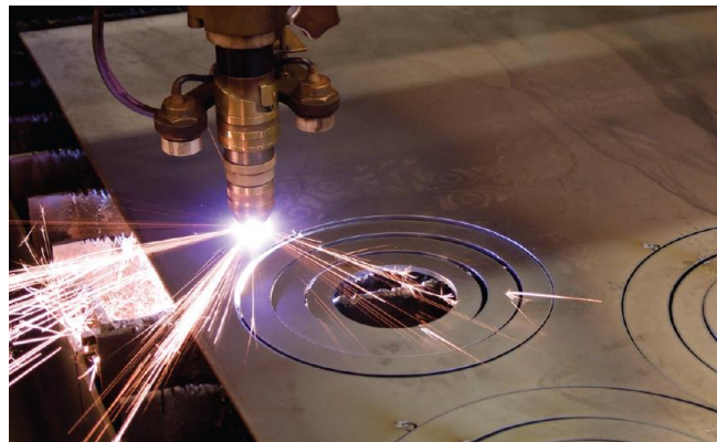
Figura 4 – Corte automatizado de chapa utilizando o plasma em aço galvanizado
