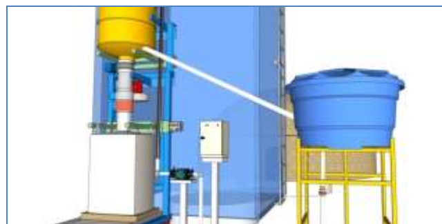
Figura 3 – Sistema de Tratamento e Utilização de Água para o Filtro Atmosférico
