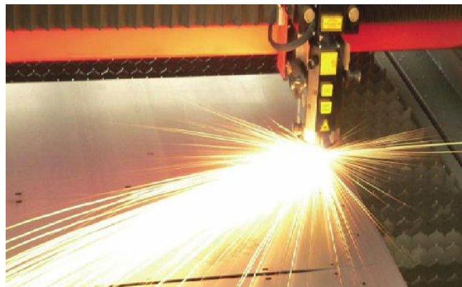
Figura 3 – Corte automatizado de chapa a laser em aço galvanizado
