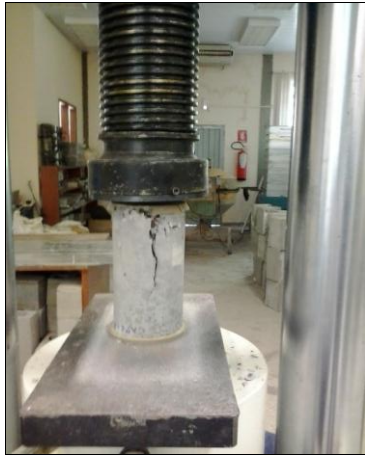
Figura 3 - Determinação da resistência à compressão
