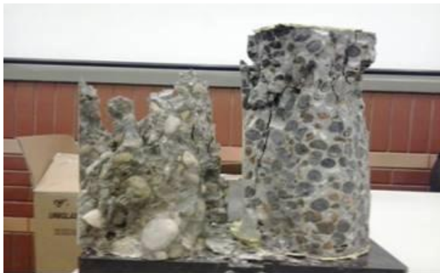
Figura 1 - Comparação de ruptura entre o concreto leve e o convencional
