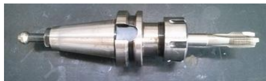
Figura 9 – macho de aço rápido com ponta helicoidal. Fonte: os autores, 2014.
