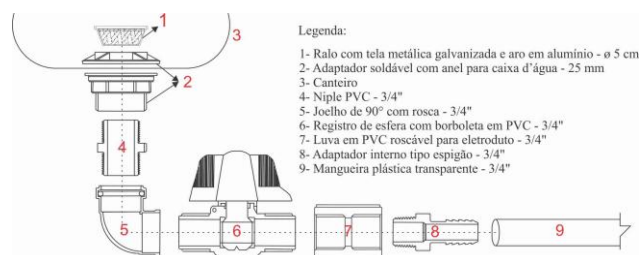
Figura 2 – Ilustração da montagem do dreno
