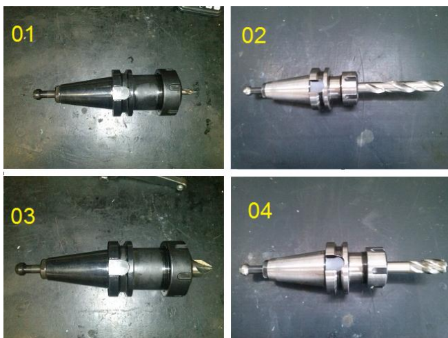
Figura 3 – ferramentas 1º lote. 01 – broca de centro; 02 – broca helicoidal; 03 – escareador; 04 – macho helicoidal. Fonte: os autores, 2014.
