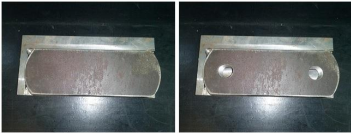
Figura 1 – material bruto x material usinado Fonte: os autores, 2014.
