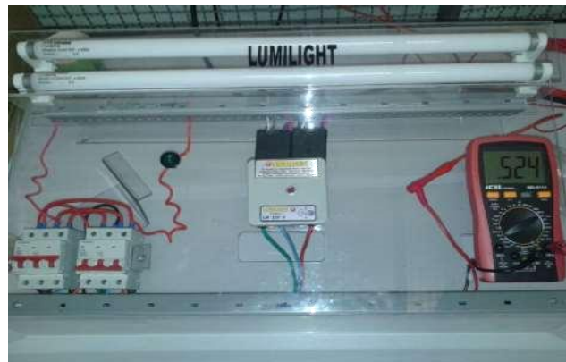
Figura 3 – Arranjo experimental ilustrando a presença de ruído na rede sem a ação do filtro
