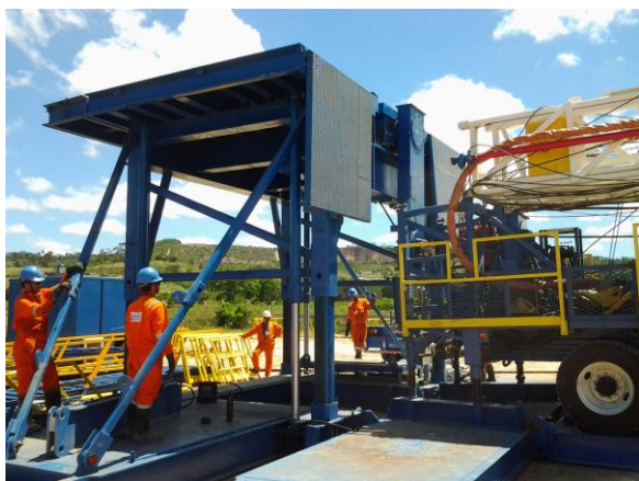
Figura 1. Subestrutura do mastro.
