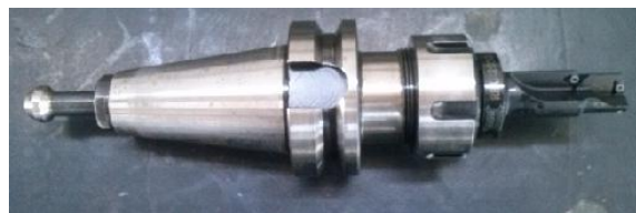
Figura 8 – broca com pastilhas intercambiáveis (pastilhas não montadas) (Fonte: os autores, 2014)
