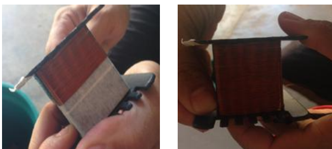
(a) Meio do carretel. (b) Extremidades do carretel. Figura 4 – Enrolamento da bobina.
