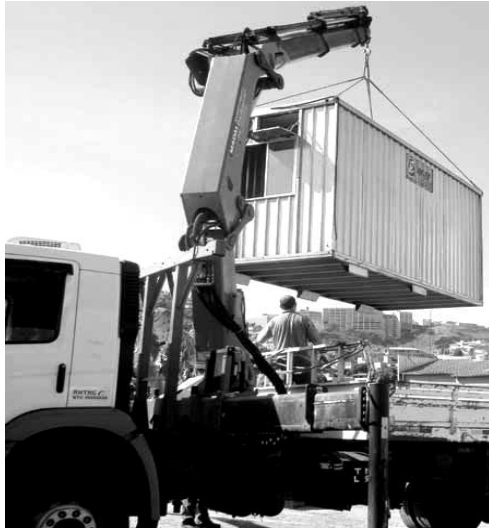
Figura 2- Içamento de contêiner com caminhão tipo Munck. Fonte: www.lafaetelocacao.com.br.
