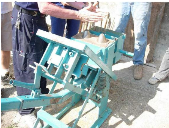
Figura 6 - Fôrma da prensa para o Bloco Mattone
