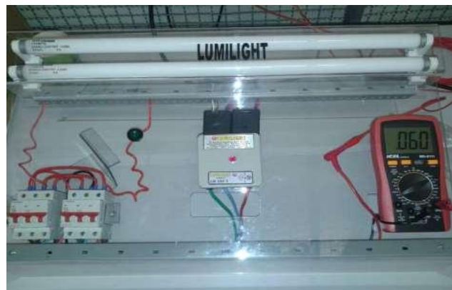
Figura 4 – Arranjo experimental ilustrando a presença de 60 Hz na rede após a ação do filtro.
