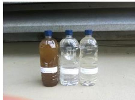
Figura 7 – Amostras retiradas da entrada e saída da ETE e da saída da usina respectivamente
