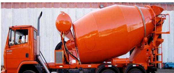
Figura 4 – Foto de uma autobetoneira hidráulica, modelo MT18
