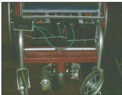
Figura 2: Instalação das Baterias e dos Motores em uma Cadeira de Rodas Convencional
